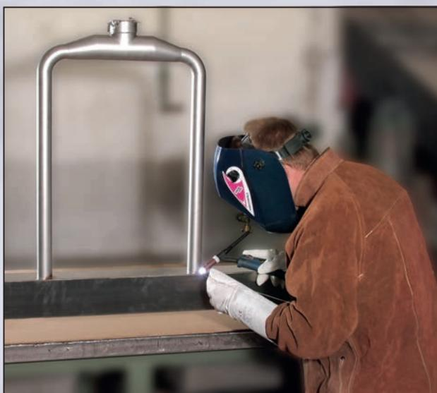
**Schweißen** und Schweißnahtvorbereitung setzen hohes Können und Werkstoffkenntnisse voraus. Alle gängigen Metalle werden bei uns fachkundig geschweißt. (Chrom-Nickel-Stähle, Aluminium, Stahl) Unser Spezialgebiet: Dünnschweißarbeiten mit feinsten Schweißnähten und geringstem Materialverzug.
