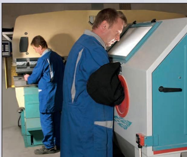
**Glasperlenstrahlen** ist eine unserer Oberflächenbehandlungen (VA). Auch Schleifen verschiedener Korngrößen, Bürsten und Hochglanzpolieren sowie das Beizen zählt zu unseren Aufgabenbereichen. Beim Apparatebau aus Stahlblech liefern wir auch in pulverbeschichteter Ausführung. Für den Transport vorbereitet, werden die empfindlichen Teile mit großer Sorgfalt verpackt.
